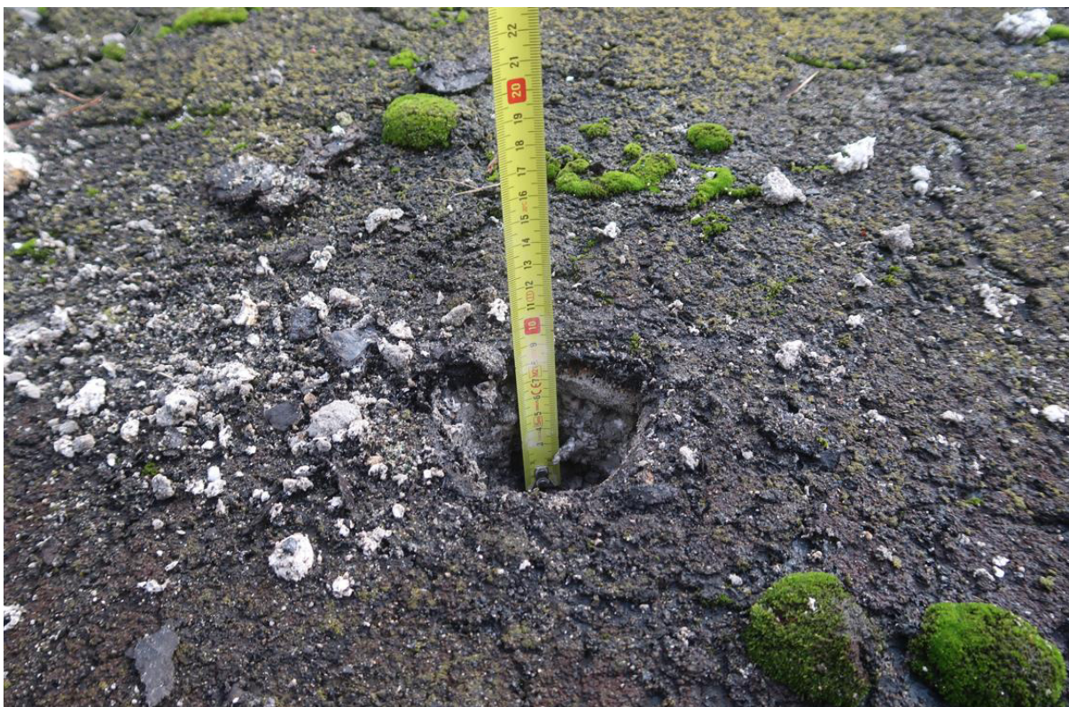
Fot. 30. Odkrywka O.12 stropodachu. W odkrywce stwierdzono pokrycie z 2x papy, termoizolację ze styropianu gr. 8cm oraz folie PE ułożoną bezpośrednio na stropie gęstożebrowym. Na folii stwierdzono duże zawilgocenie.
